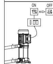
2. La pompe électrique doit être reliée correctement à la terre afin d'éviter tout court-circuit ; pour des raisons de sécurité, l'installation devra être équipée d'un disjoncteur magnétothermique correctement calibré.
