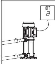
7. Il se peut que le liquide soit chaud et sous pression ; avant de déplacer et démonter la pompe, les vannes à l'aspiration et au refoulement de la pompe doivent être fermées avant de vidanger la pompe et les tuyaux et éviter ainsi d'être ébouillanté.
