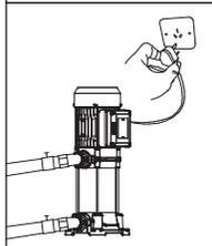
9. S'assurer que la pompe ne peut pas être accidentellement alimentée pendant son installation et sa maintenance ; si elle n'est pas utilisée pendant un certain temps, couper son alimentation et fermer les vannes à l'aspiration et au refoulement.
