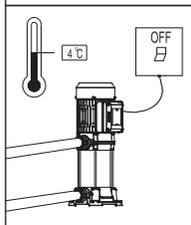
6. Dans le cas où la température ambiante est inférieure à 4°C ou lorsque la pompe n'est pas utilisée pendant un long moment, vidanger la pompe pour éviter que le gel détériore le corps de pompe.
