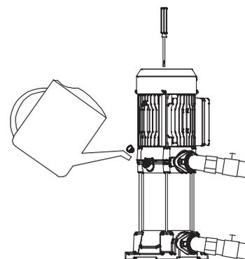
Faire tourner les pales de ventilateur avant le démarrage, afin de vérifier que la rotation est facile et avant de dévisser le bouchon d'amorçage et de remplir le corps de pompe avec de l'eau claire ; resserrer le bouchon après avoir extrait tout l'air. La vanne doit être fermement fermée lors du démarrage de la pompe.
