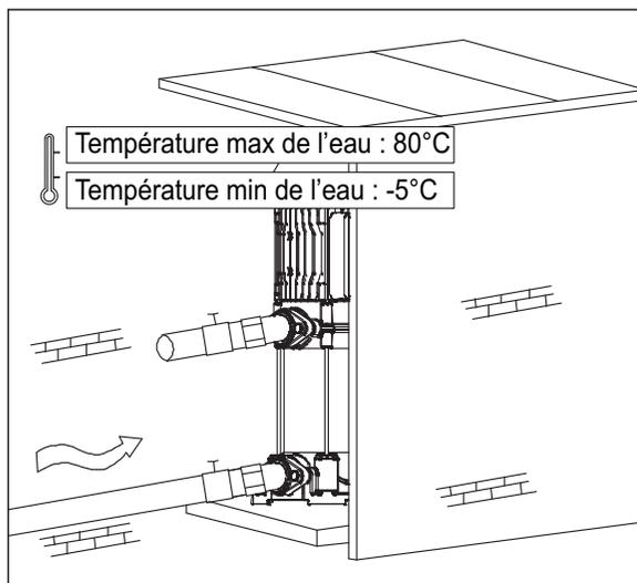
1. Pour l'installation de la pompe, la conduite d'aspiration doit être aussi courte que possible. La pompe doit être installée dans un environnement sec et ventilé. Elle peut être installée à l'extérieur, à condition d'être protégée des intempéries.
